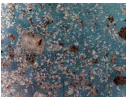
Рис. 2. Мікроскопічний аналіз структури та дисперсності дослідних зразків ґрунтів: БД-1, БД-2 – відібрані з ділянок після вибуху, К – контрольний зразок
